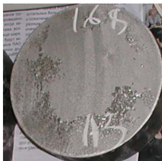
Рис. 2. Макроструктура поковки жаропрочного сплава ХН77ТЮР-ВД, содержащего 20,13 % хрома, 75,09 % никеля, 0,91 % алюминия, 2,74 % титана, 0,06 % углерода, 0,38 % железа
