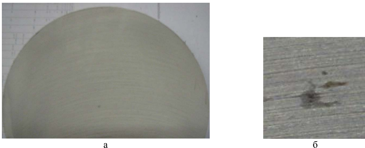
Рис. 3. Макроструктура поковки (а) и фрагмент поковки (б) с осевой пористостью слитка, не заварившейся при деформации
